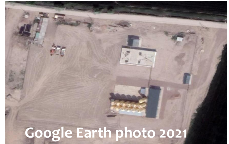
КОС гор. Нурафшан Производительность 4000 м 3 /сут. 2019-2022 (1я очередь), Ташкентская обл., Узбекистан
